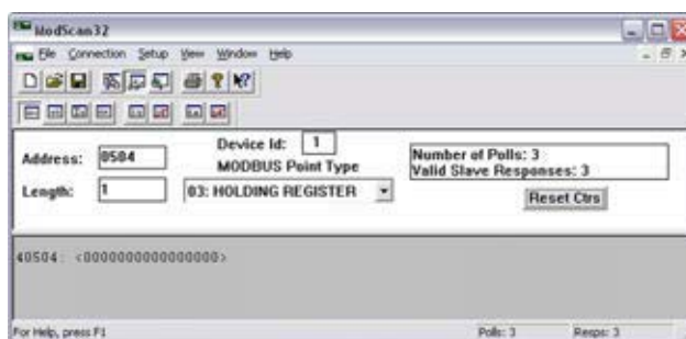
Fig. 231: Modbus - remote control parameter 503
